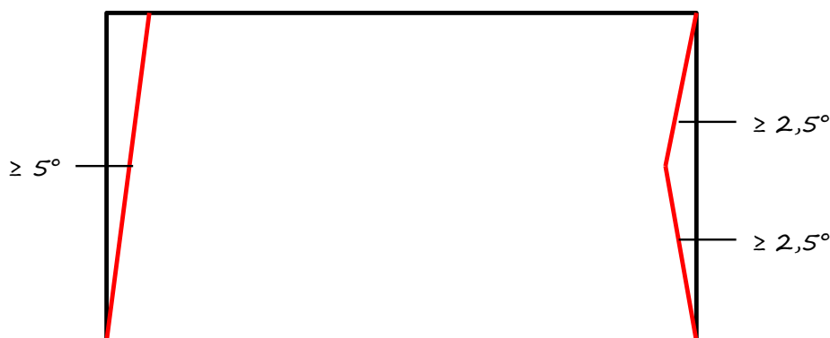
Abbildung 2: Schnitt mit schematischer Anordnung schräger Wände
