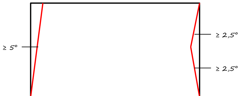
Abbildung 2: Schnitt mit schematischer Anordnung schräger Wände
